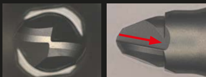
Направление отвода стружки
